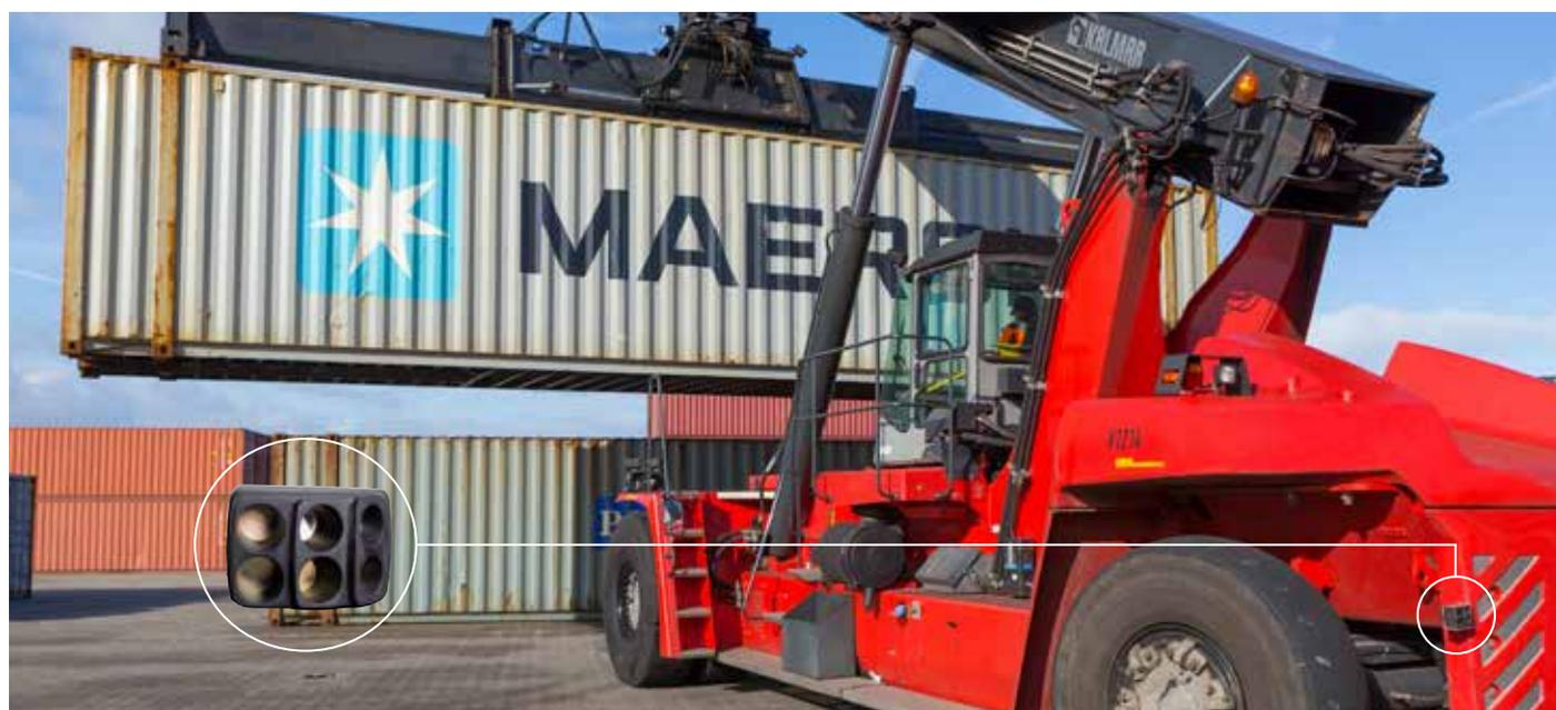
Deteção de obstáculos instalado num reach stacker, permitindo ao operador concentrar-se no container.
